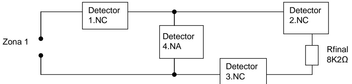
La alimentación de continua de salida para los distintos detectores es un poco más alta, unos 13,8 Voltios, que es la tensión de carga de batería así como también es optima para evitar las pequeñas caídas de tensión que se producen en todo el recorrido del cableado de la instalación. En este caso, también es recomendable, que a longitudes largas se utilicen manguera con hilos de mayor sección, especialmente para las conexiones de alimentación de al menos  $1\text{mm}^2$ .
