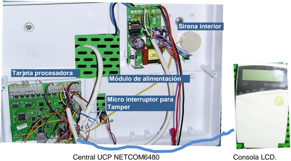
En la siguiente figura se muestra las distintas conexiones de la placa de control del sistema NETCOM 6480.
