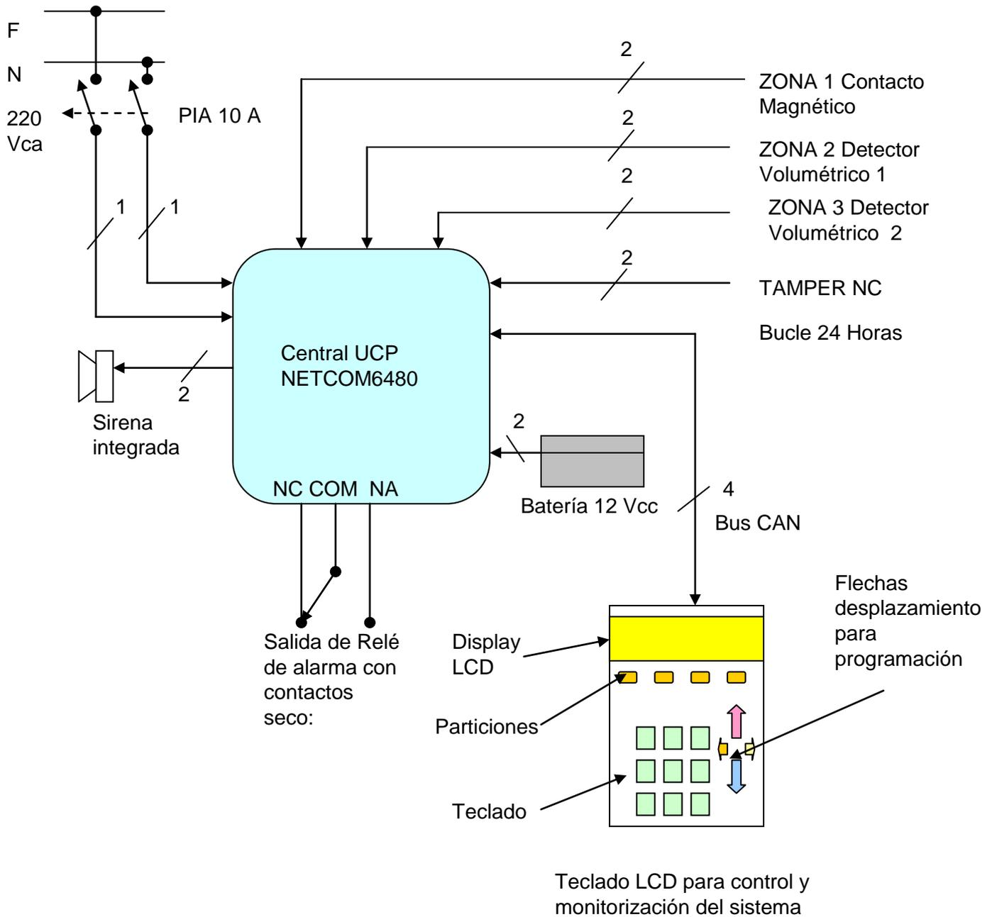
Realizar las siguientes pautas de montaje de todos los elementos y detectores de la central NETCOM 6480:
