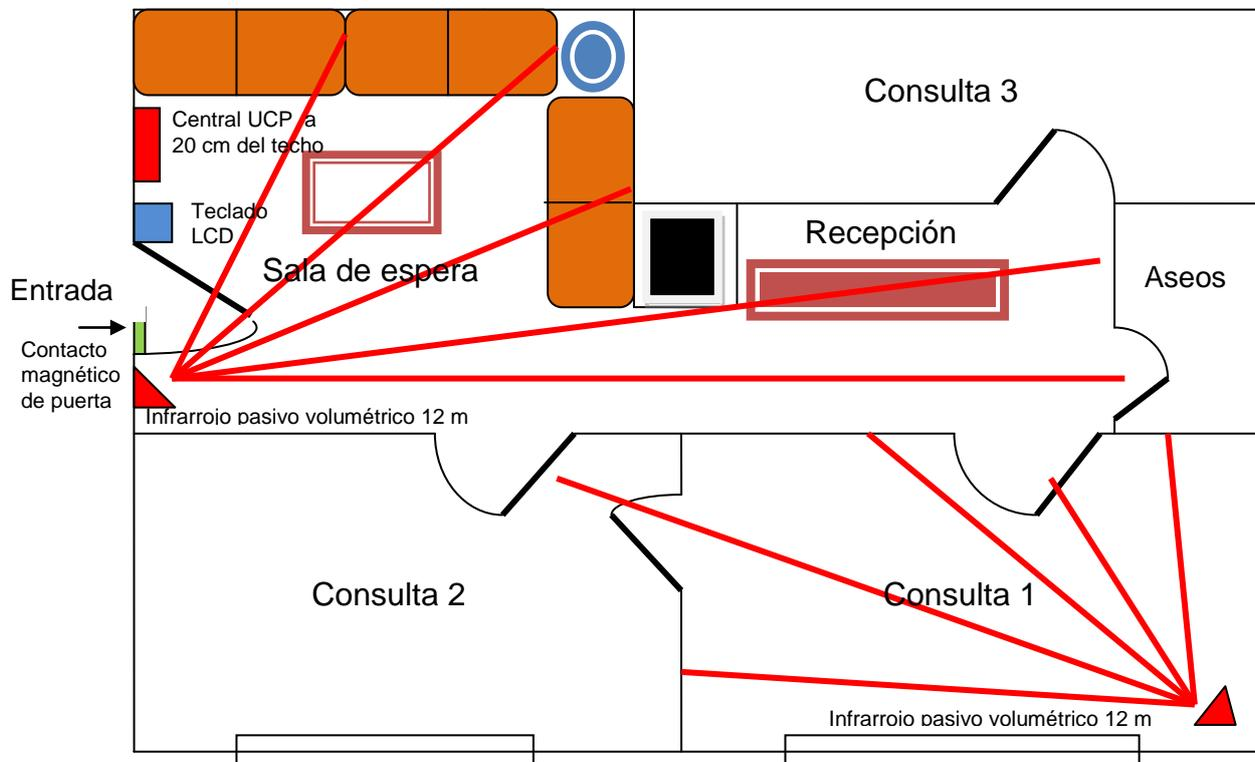
El sistema se compone de una central procesadora NETCOM 6480, dos detectores volumétricos pasivos de 12 metros, un contacto magnético de puerta, un teclado de control LCD y una batería de 12 V y 7 Amperios.
